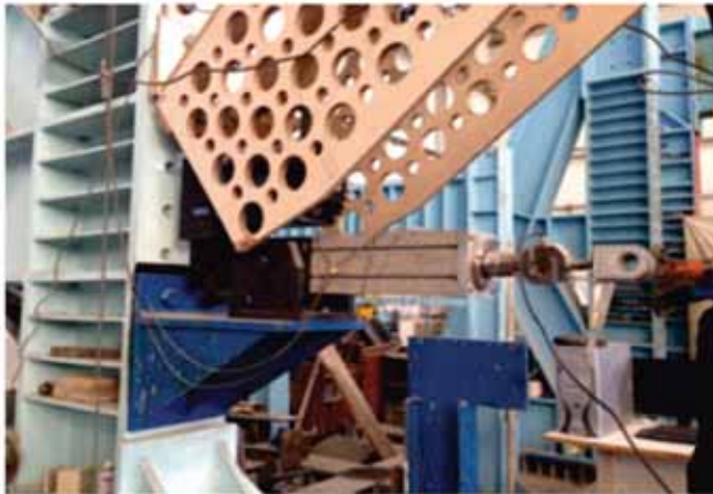
شکل ۳- دستگاه جک بارگذاری ۲ تن
