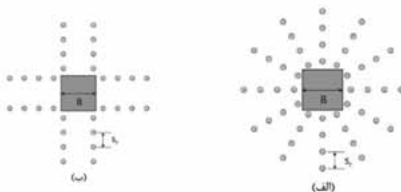
شکل ۶ دو الگوی متداول قرارگیری پیچ‌های برشی، شبکه‌ها و بادبزن‌ها: الف) شعاعی: ب) متعامد [۲]
