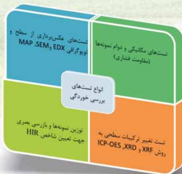
شکل ۲: انواع تست های بررسی خوردگی
