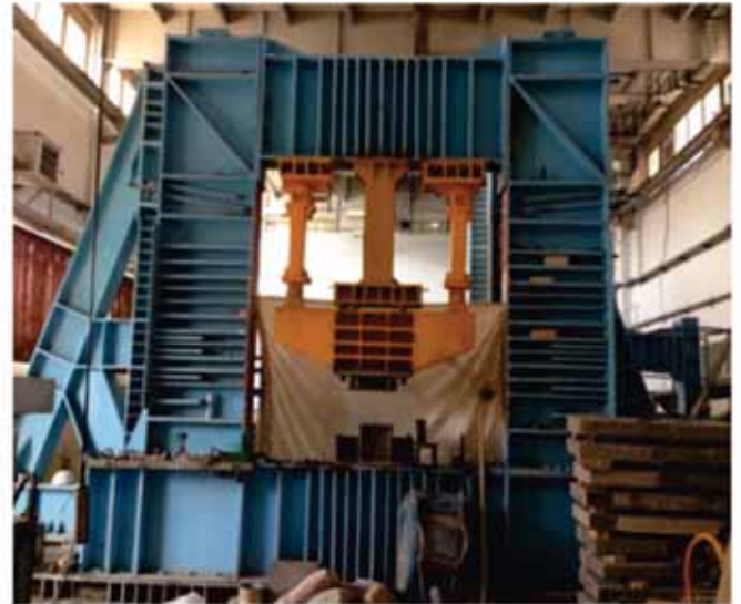
شکل ۱- Reaction frame و Setupهای انجام آزمایش میراگر
