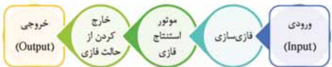
شکل ۳- بخش‌های مختلف یک سیستم استنتاج فازی
